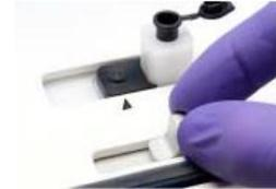
5. Finalizada la asociación, abrir la tapa y deslizar de nuevo el *slider* hacia la izquierda para iniciar la disociación, lavando así el exceso de proteína con el mismo *buffer* utilizado para el equilibrado.
