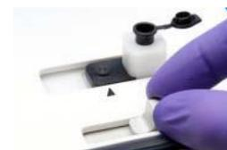
2. Seguidamente colocar la punta, alineándola con el *slider* al *ependorf*, **cerrar la tapa del tirón para evitar que comience a medir antes de que la punta entre en contacto con la muestra**. Debe realizarse a la mayor brevedad posible para así evitar que la punta se seque.
